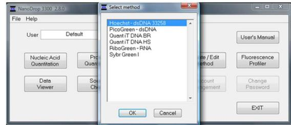
Par exemple, l'application PicoGreen® est configurée pour mesurer la fluorescence du colorant PicoGreen®. La fluorescence du complexe ADN double brin-PicoGreen® peut être mesurée à  $525 \pm 20$  nm grâce à la LED bleue. En utilisant 2 µL de votre échantillon, la sensibilité pour le dosage de PicoGreen® est d'environ 2 pg, et la gamme linéaire est de 1 ng/mL à 1000ng/mL.
